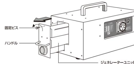
④ ジェネレーターユニットがしっかりとセットされたことを確認し、固定ビスを締めて固定してください。
