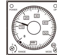
スイッチを「ON」にした時から設定時間だけオゾンが発生します。
