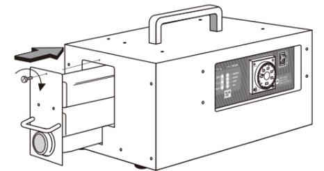
② オゾン吹き出し口側から水道の流水で中を洗浄します。
