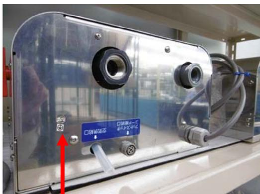
本体のアースビスを外し、アース線の圧着端子を確実に固定します。
