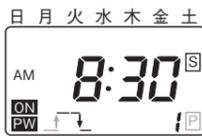
③消去を押します。(一回の操作でON/OFFの設定が同時に消去されます。出力は消去前の状態を保持します。)
