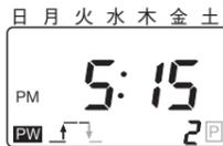
⑦セットを押します。モードを押して、動作曜日設定モードにします。
