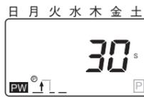
④モードを押して動作曜日設定モードにします。動作曜日の設定内容が表示されます。
