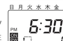
④モードを押して動作曜日設定モードにします。動作曜日の設定内容が表示されます。(修正がある場合は曜日送りとセットで修正します。)
